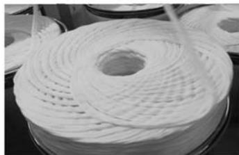
图 5 并条机大圈条卷装叠层比例
